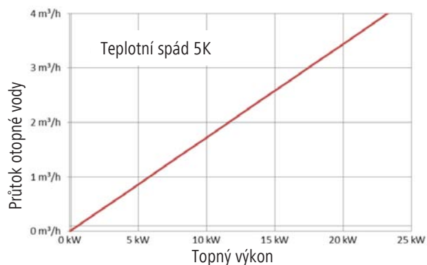
Obr. 27: Průtok vody při teplotním spádu 5K
