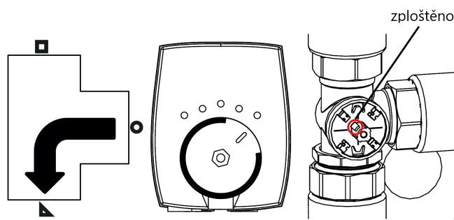
Obr.40: Poloha přepínacího ventilu v režimu topení
